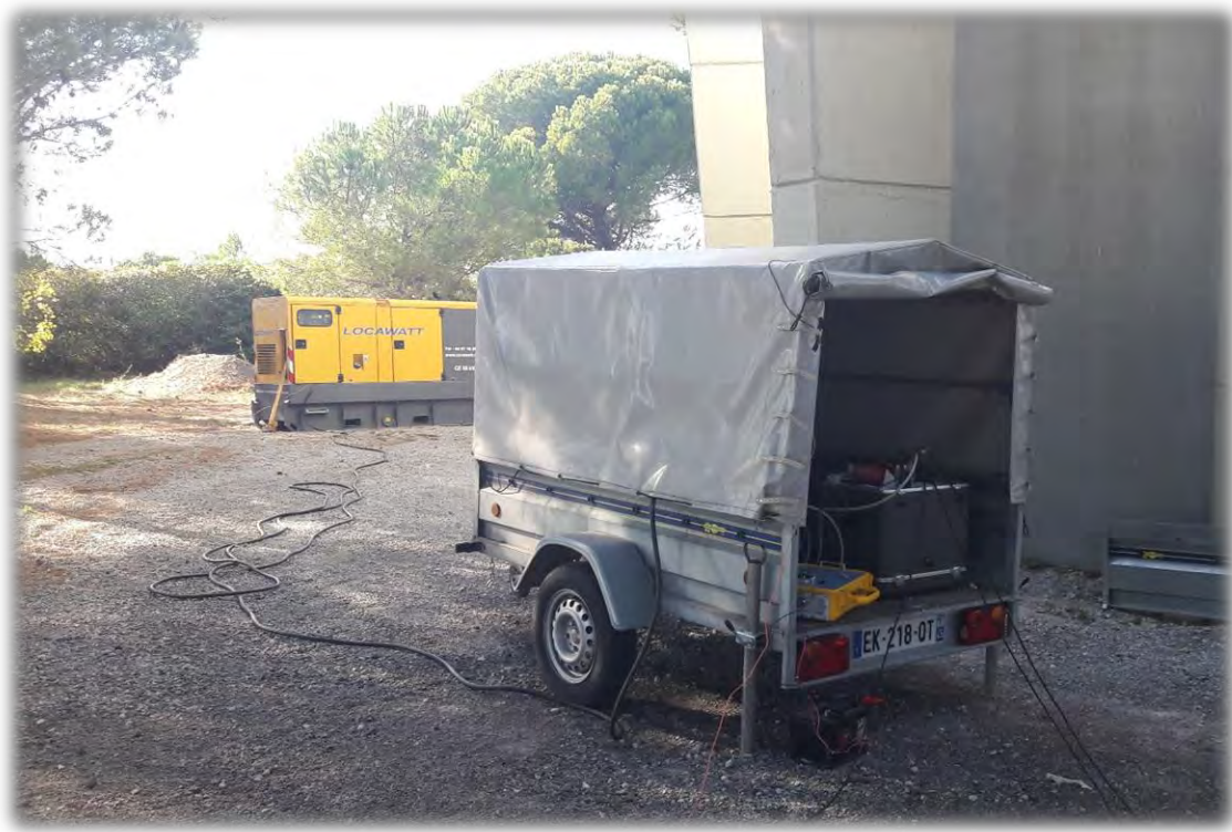
Illustration 6 - TX-Loupian (groupe électrogène, transformateur d'isolement, TXM22).
