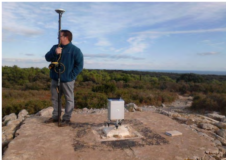
Illustration 28 - Premier plan : gravimètre CG5 en cours d'acquisition sur la base absolue de l'IGN Gigan I, second plan : GPS Trimble Geo7X (pas en cours d'acquisition) .
